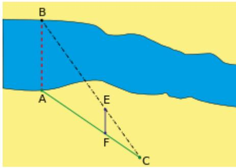
Zur Bestimmung der Flussbreite  $\overline{AB}$  wurden die folgenden Hilfsstrecken eingemessen.
